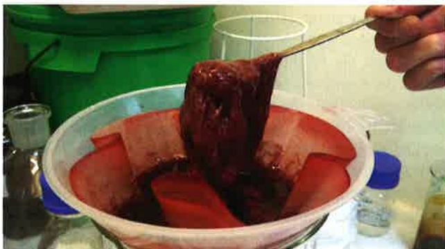
Visualisiertes Filtrationsproblem – isoliertes Glucan aus Himbeeren. © alle Erbslöh
